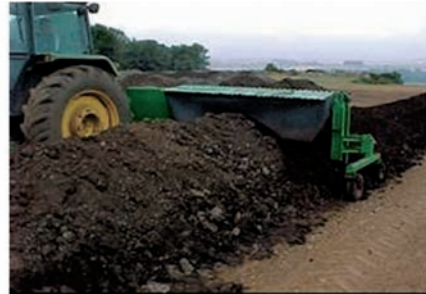
2.- Volteo de compost
