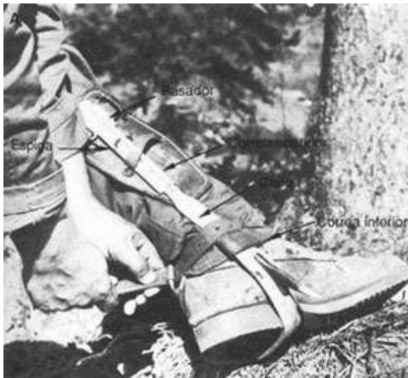
4.9 Espuelas de trepa (A) ajuste mediante correas (B) trepa. (Servicio Forestal del Canadá)
