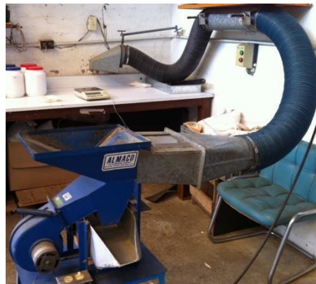
Figura 22. Venteadora - recolectora de residuos usada en varias etapas del proceso.
