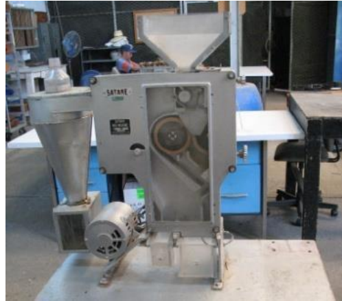
Figura 20. Máquina de fricción mecánica usada especialmente para desgranar semillas del género Stylosanthes .
