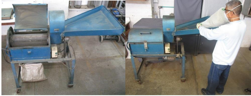
Figura 23. Máquina desgranadora, usada en el proceso de pre-limpieza del Prosopis .
